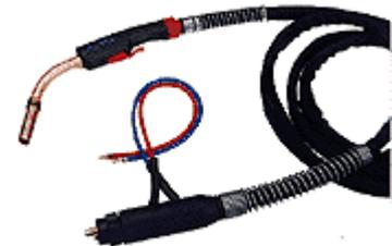
Il corpo della torcia, isolato esternamente, conduce filo, gas e corrente; termina con un ugello, dal quale fuoriesce il gas mediante un apposito diffusore, attorno ad un tubetto che porta corrente al filo che vi scorre dentro.
